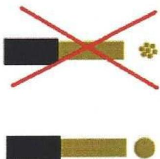
Utiliser des fils rigides ou une borne de fil sur des fils souples
